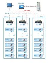
**BMS Wiring Diagram**
